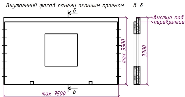
Рис. 2 - Схема наружной стеновой панели с оконным проемом Fig. 2 - Scheme of external wall panel with window opening
