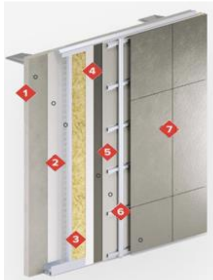
Рис. 3 – Конструкция фасадно-стенового модуля (легкий бетон 100 мм – 1; пароизоляция – 2; каркас из ЛСТК с утеплением – 3; гидро-ветрозащита диффузионная – 4; Аквапанель 12.5 мм – 5; двойная обрешетка из Омега-профилей 44 мм – 6; фиброцементные плиты 10 мм – 7) [46] Fig. 3 – The design of the facade-wall module (lightweight concrete 100 mm - 1; vapor barrier - 2; LSTK frame with insulation - 3; diffusion hydro-wind protection - 4; Aquapanel 12.5 mm - 5; double crate of Omega-profiles 44 mm - 6; fiber cement slabs 10 mm - 7) [46]
