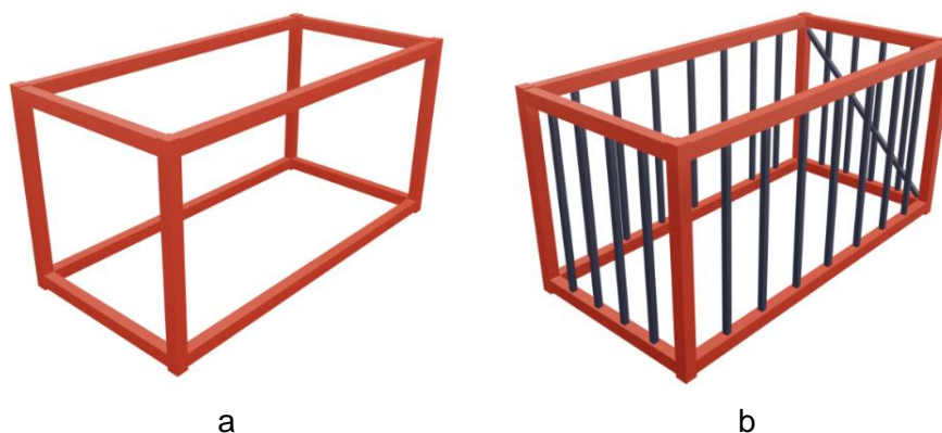
Рис. 6 – Несущие стальные модули (а) с опорой на четыре колонны (б) с непрерывной опорой на колонны
