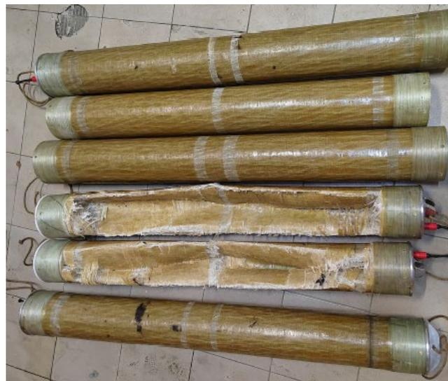
**Рис. 2 - Внешний вид гибридных стеклобазальтопластиковых труб после процесса разрушения**
