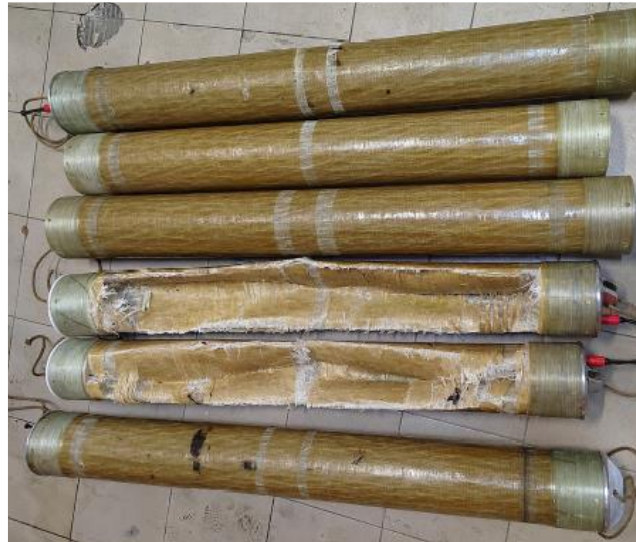
Рис. 2 - Внешний вид гибридных стеклобазальтопластиковых труб после процесса разрушения Fig. 2 - Appearance of hybrid glass-basalt-plastic pipes after the destruction process
