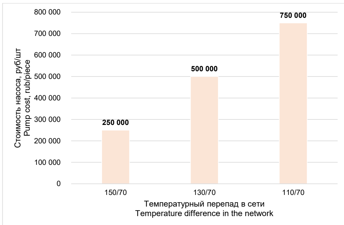
Рисунок 7. Стоимость насосного оборудования при различном температурном режиме Figure 7. The cost of pumping equipment at different temperatures
