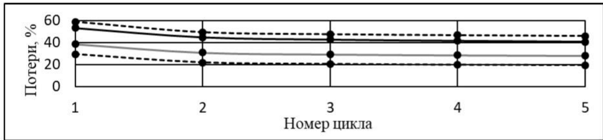
Рис. 6. Зависимость потерь от порядкового номера цикла при максимальном напряжении 10, 20, 30 40 МПа (сверху вниз).
