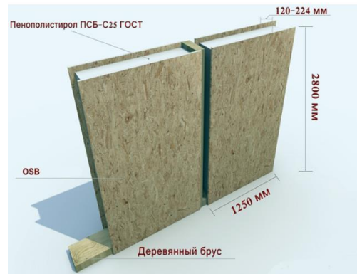
Рисунок 1. Структура SIP панели [5]
