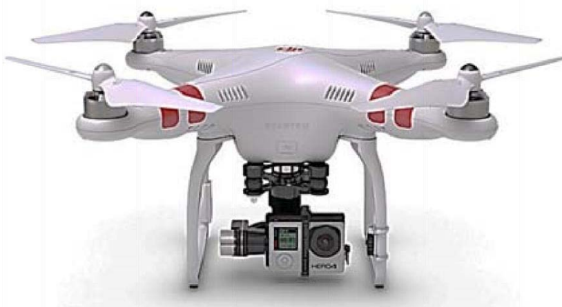
Рисунок 2. Phantom 3 с подвесом Zenmuse H4-3D и камерой
