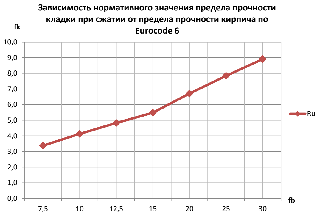
Рисунок 1. График зависимости нормативного сопротивления сжатию от приведенного сопротивления сжатию кирпича при заданном одинаковом растворе f_k ( f_b ).
