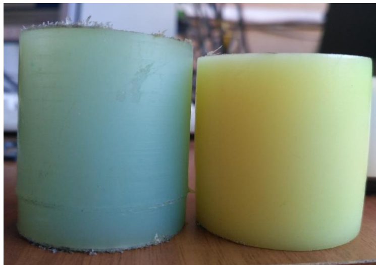
Рис.2. Справа образец сразу после 30% деформации, слева - образец в естественном состоянии.
