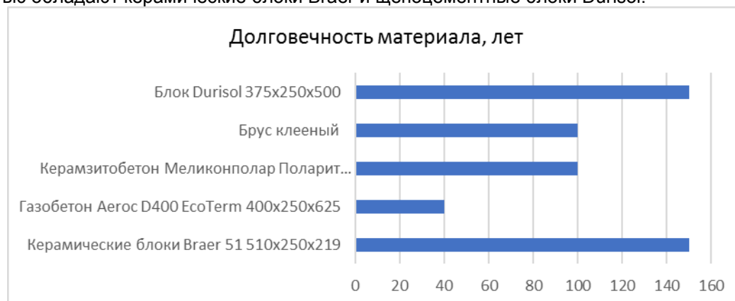
Рисунок 2. Показатели долговечности отобранных стеновых материалов
