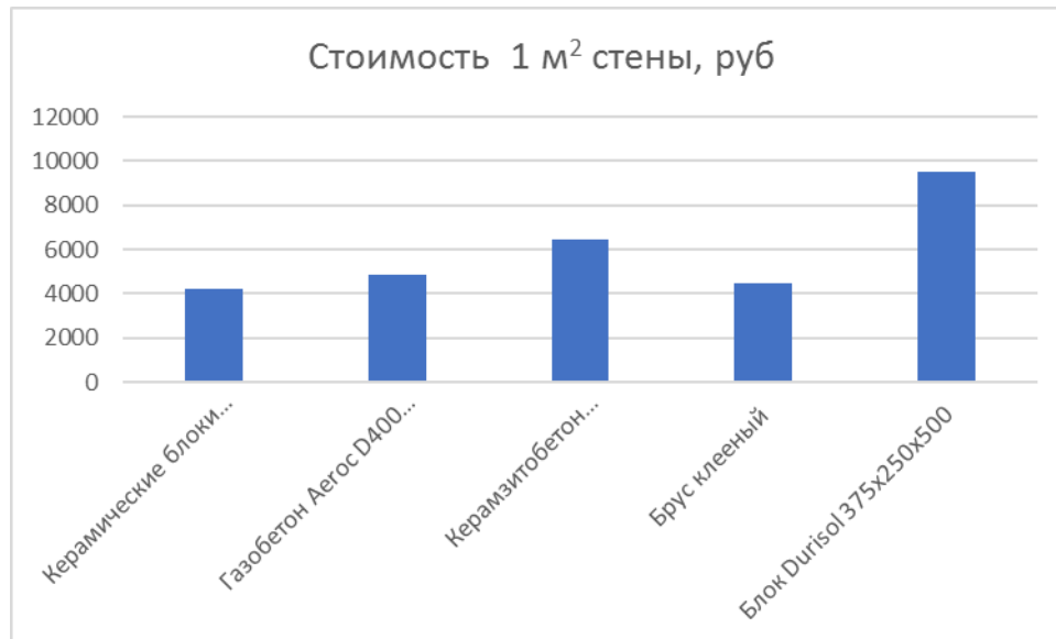
Рисунок 4. Диаграмма стоимости 1 м 2 стены, выполненной из отобранных стеновых материалов
