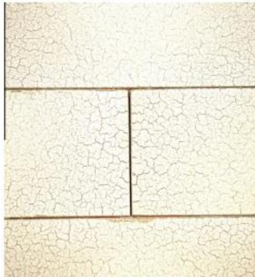
**Рис.5. Сторона стены из автоклавного газобетона (125 мм), подвергшаяся испытанию по стандарту ISO 834 в течение 220 минут**
