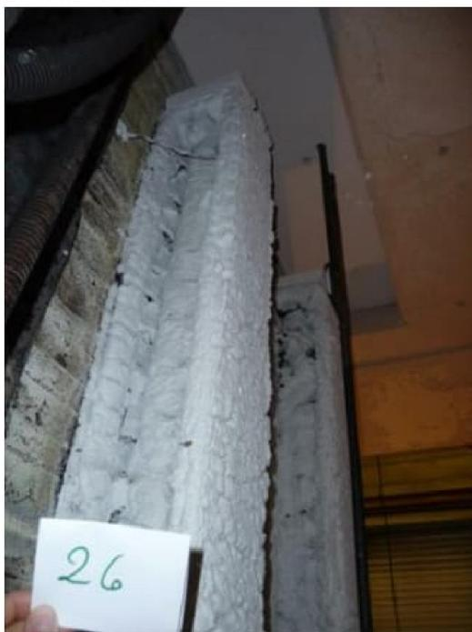
**Рис.3. Колонна со вспучивающимся покрытием после одного из испытаний на огнестойкость**
