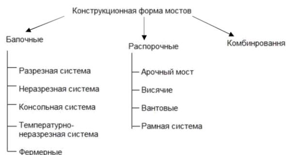
Рис.1. Классификация мостовых конструкций
