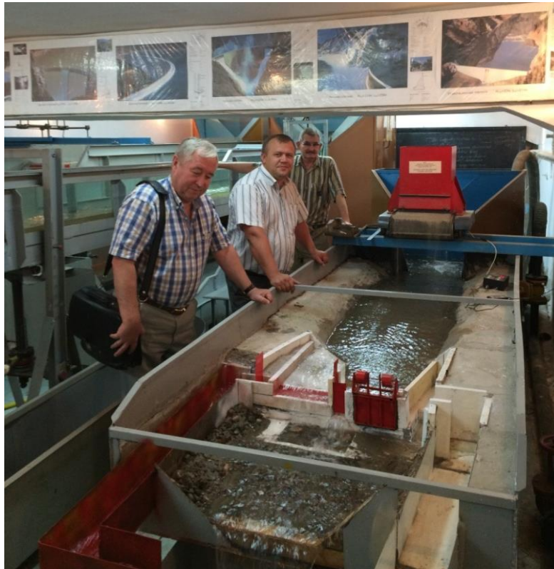
Рисунок 2. Физическое моделирование водозабора на р. Асса в лаборатории кафедры ГТСИВР КРСУ
