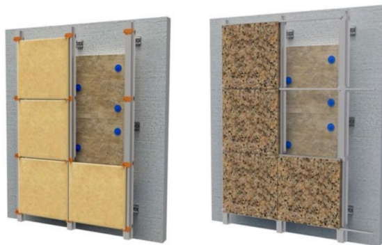
Рисунок 2 - Система с креплением в стены
