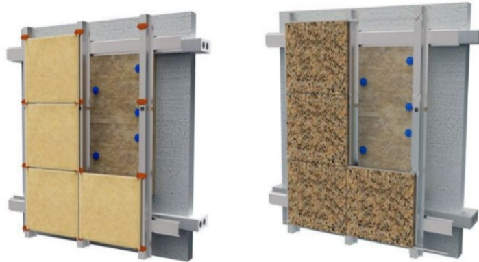
Рисунок 3 - Система с креплением в межэтажные перекрытия
